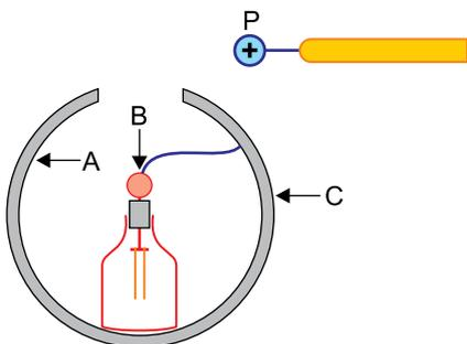
A demonstração consistiu em observar como se comportavam as folhas do eletroscópio quando o professor encostava uma esfera condutora P, mantida sempre positivamente eletrizada e fixa em um bastão isolante, nos pontos A, B e C. A demonstração seguiu os seguintes passos consecutivos:
